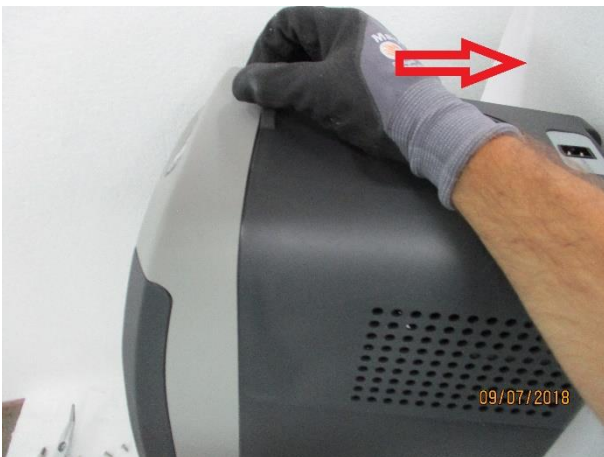
3. Remove the carter (pull strongly)
