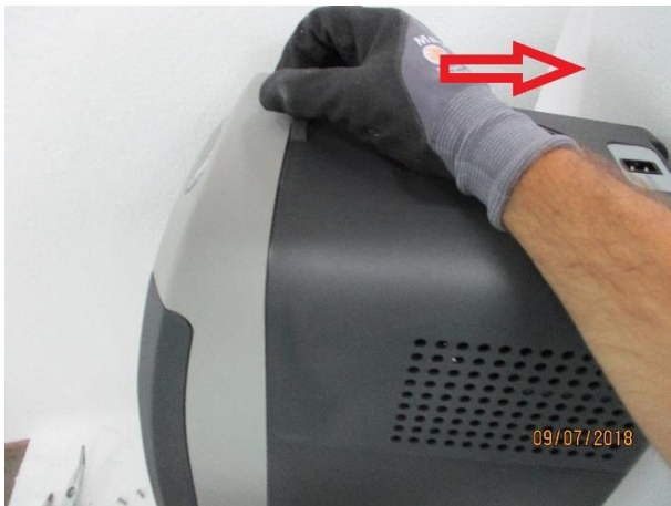
3. Remove the carter (pull strongly)
