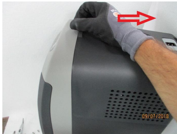
3. Remove the carter (pull strongly)
